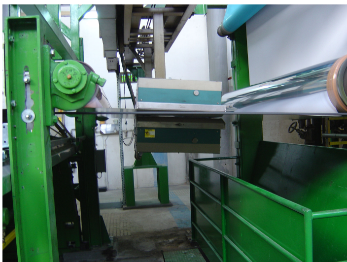
Uporaba merilnika z radioizotopom Kr-85 za merjenje gramature papirja
