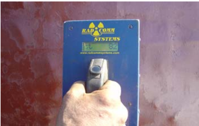
Merilnik sevanja, ki ga uporablja lastnik odpadnih kovin
