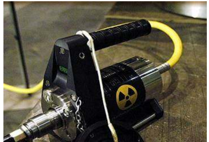
Vsebnik z visokoaktivnim virom sevanja Se-75
