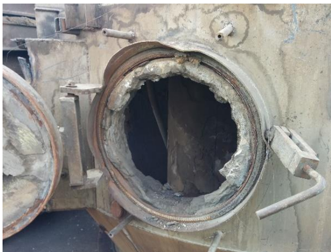
Del izrabljene industrijske peči z oblogami s povišano vrednostjo naravnih radionuklidov (Foto: ZVD d. o. o.)
