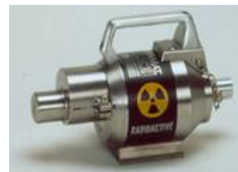
Prenosna naprava za industrijsko radiografijo, ki vsebuje več kilogramov osiromašenega urana
