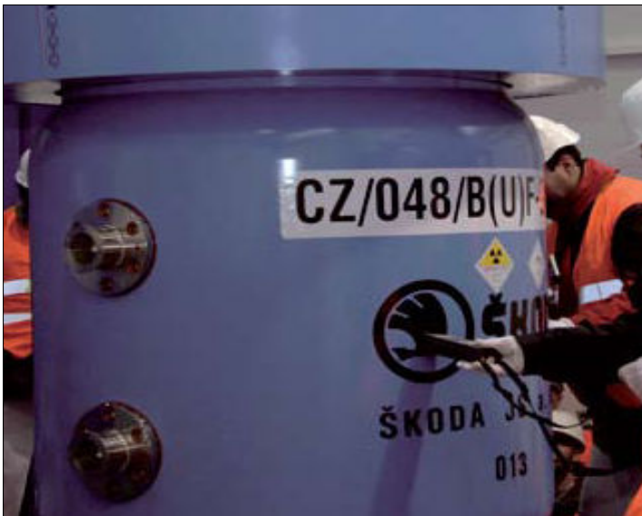
Vsebnik za prevoz izrabljenega jedrskega goriva (Foto: IAEA Bulletin, 2007)
