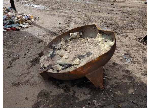
Šamotna obloga s povišano vrednostjo radionuklidov, najdena v pošiljki odpadnih kovin v podjetju Surovina d.o.o. na lokaciji v Mariboru. (Foto: ZVD d. o. o.)
