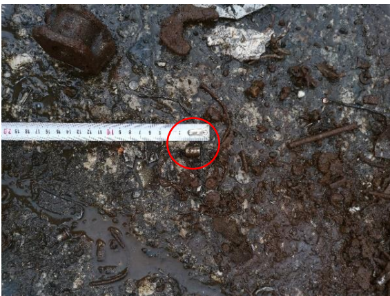
Radioaktivni odpadek z ^{152}\text{Eu} z aktivnostjo približno 1 GBq, najden med sekundarnimi surovinami (Foto: ZVD d. o. o.)
