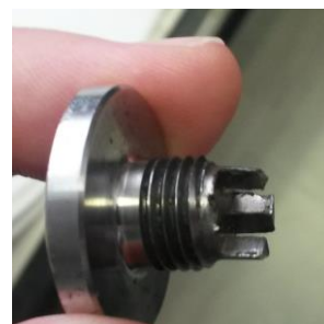
Nepoškodovan varnostni vijak (levo), po Troxler specifikacijah t. i. »cap screw«
