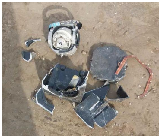
Številčnica žiroskopskega navigacijskega inštrumenta z radiofluorescenčno barvo z ^{226}\text{Ra} (Foto: ZVD d.o.o.)
