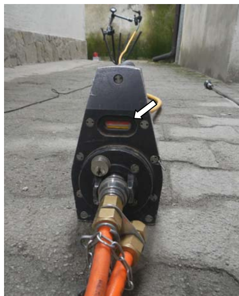
Indikator, ki kaže, da vir ni ustrezno pospravljen v vsebnik defektoskopa (Vir: ZVD d.d.)
