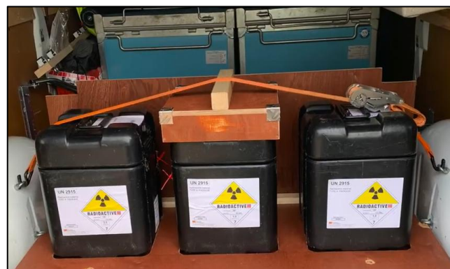
Slika 3: Primer označenih in pritrjenih tovorkov (vir slike:
