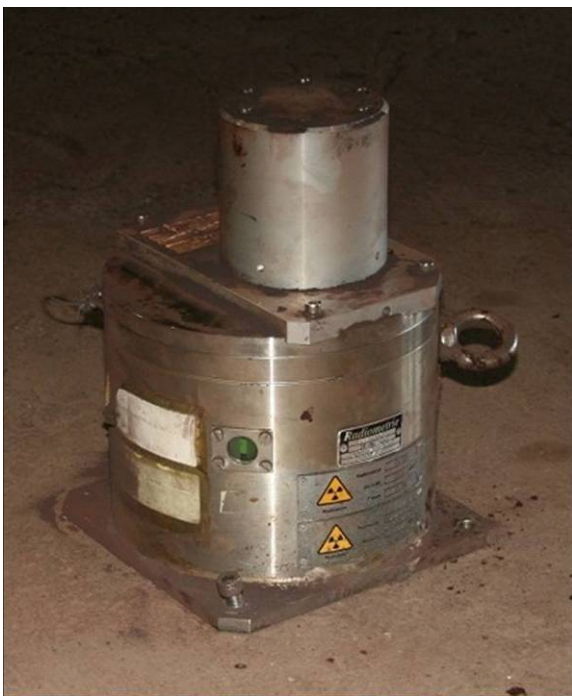
Vsebnik iz osiromašenega urana z virom sevanja ^{137}\text{Cs} , kupljen leta 2001, začetna aktivnost 1,11 TBq
