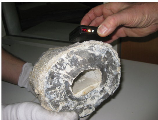
Del okla mastodona s povišano vsebnostjo naravnih radionuklidov. Oznaka 3 na indikatorju pomeni približno šestkratno dozno polje, ki je sicer prisotno na naravnem ozadju. (Foto: inšpekcija URSJV)
