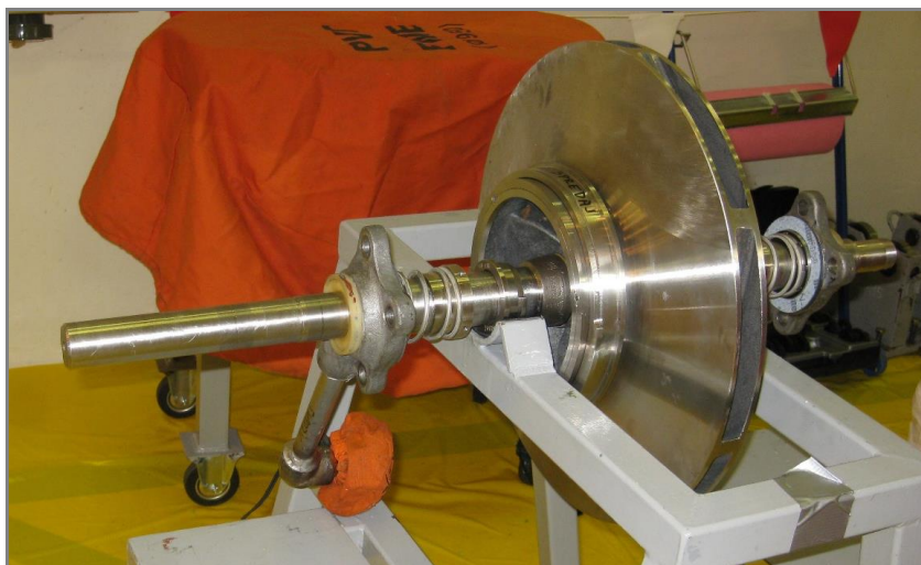
Slika 66: Rotor SF črpalke 1 (SFAPSF01) (Foto: inšpekcija URSJV)
