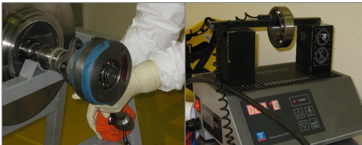
Slika 67: Montaža radialnega ležaja na gred SF črpalke (levo), segrevanje ležaja SF črpalke pred montažo na 60 °C (desno) (Foto: inšpekcija URSJV)
