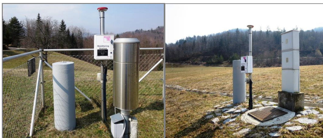
Slika 77: Opazovalna točka GPS nadzora stabilnosti območja odlagališča Boršt GMX1 na lokaciji vremenske postaje Boršt – Gorenja vas (levo) in opazovalna točka GPS nadzora stabilnosti območja odlagališča Boršt GMX2 na zgornji etaži odlagališča (desno)
