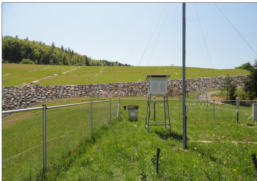
Slika 97: Avtonomna postaja za meritve zunanjega sevanja (v levem kotu), začasno postavljena na območju odlagališča Boršt
