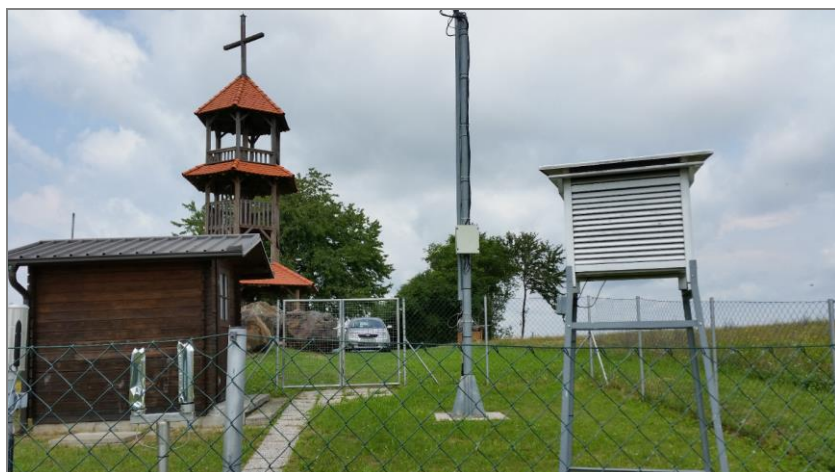
Slika 96: Merilno mesto Krajinski park Goričko (levo sta sondi za merjenje hitrosti doze ionizirajočega sevanja, desno in v ozadju je vidna meteorološka oprema)
