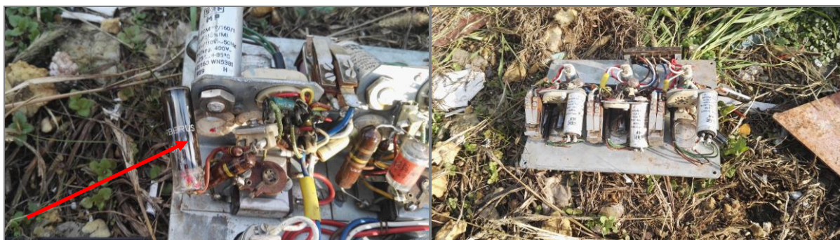
Slika 93: Elektronska cev Cerberus SR 4, ki vsebuje radioizotop ^{226}\text{Ra} je del elektronskega vezja (levo) in elektronsko vezje (desno), ki je vsebovalo več takih cevi. (Foto: arhiv ZVD d.o.o.)
