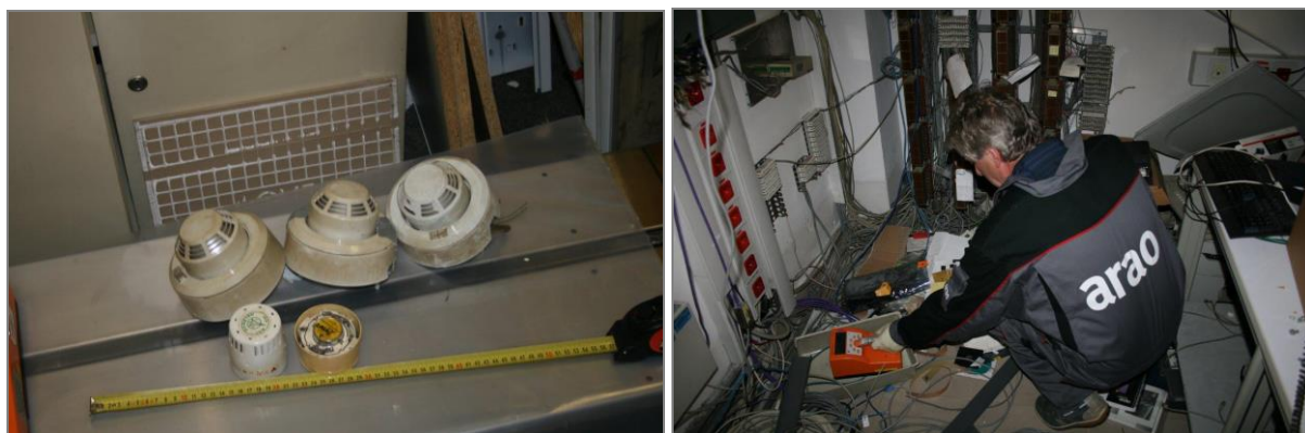
Slika 91: Najdeni JAP na lokaciji v Ljubljani (levo) in merjenje kontaminacije po opravljenem prevzemu, ki ga izvaja sodelavec ARAO (desno) (Foto: arhiv ARAO)
