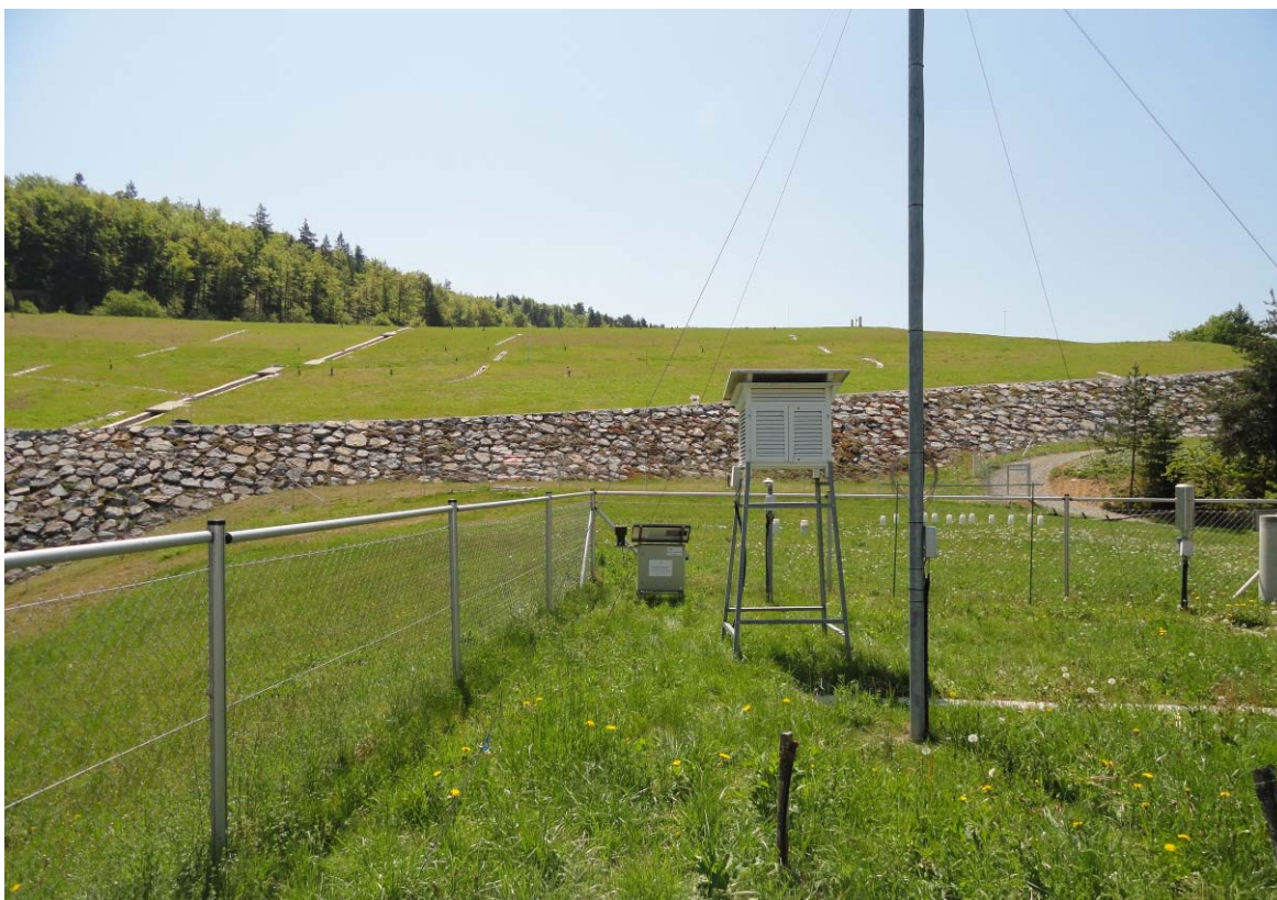
Slika 109: Avtonomna postaja za meritve zunanjega sevanja (v levem kotu), začasno postavljena na območju odlagališča Boršt
