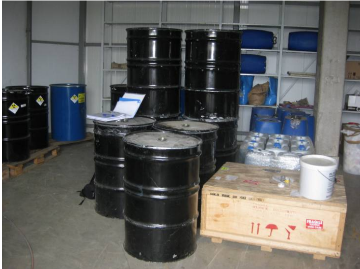
Slika 102: Hramba sodov z radioaktivnimi odpadki in z uranovimi spojinami
