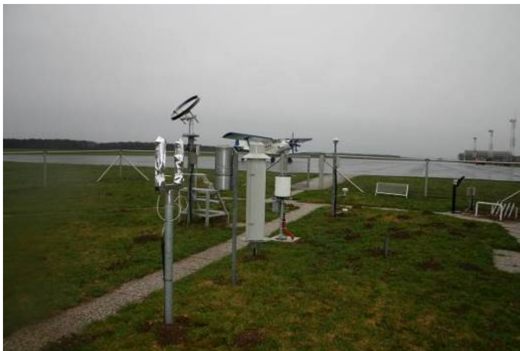
Slika 108: Merilno mesto na letališču Maribor (v ospredju sta sondi za merjenje hitrosti doze ionizirajočega sevanja, v ozadju je vidna meteorološka oprema)
