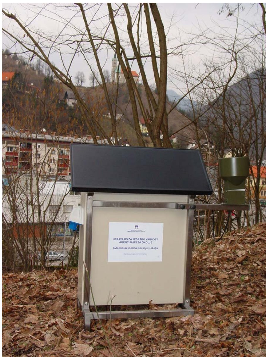
Slika 3.3: Avtonomna postaja za meritve zunanje sevanja in količine padavin, začasno postavljena na območju rudnika v Idriji
