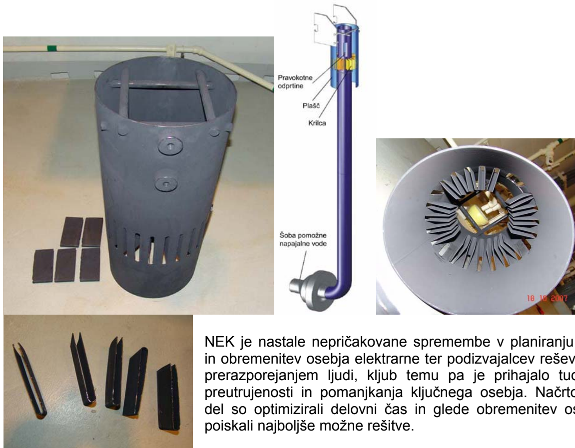
Slika 2.29: Poškodbe razdelilnikov pretoka pomožne napajalne vode
