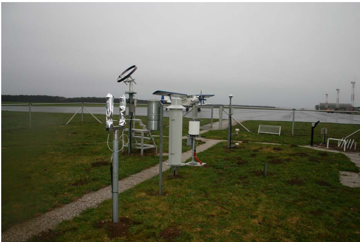
Slika 3.2: Merilno mesto na letališču Maribor. V ospredju sta sondi za merjenje hitrosti doze ionizirajočega sevanja, vidna je tudi meteorološka oprema.
