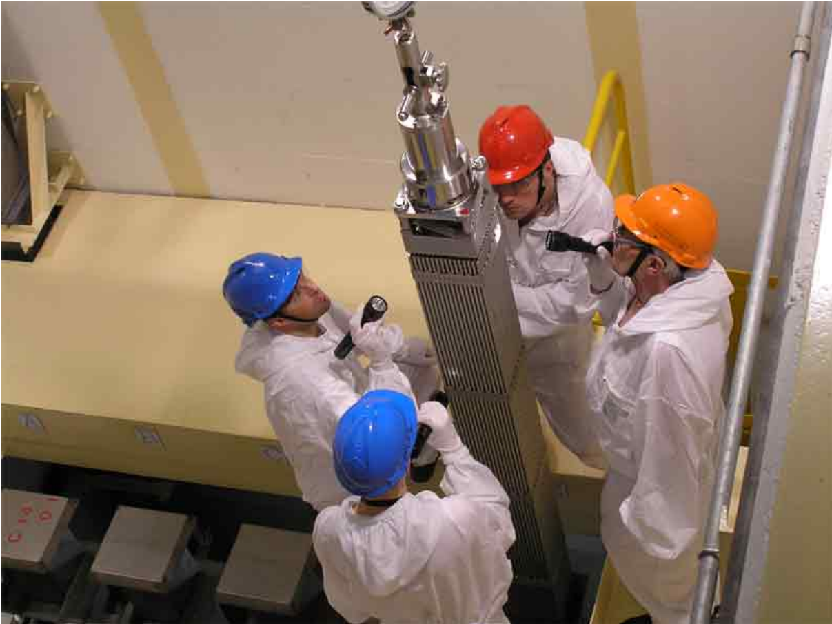
Slika 2.41: Vizualna inšpekcija svežih gorivnih elementov v NEK
