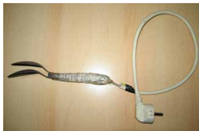
Nevarno početje – priročno narejeni grelec s hišnim imenom »taucher« lahko povzroči hude poškodbe
