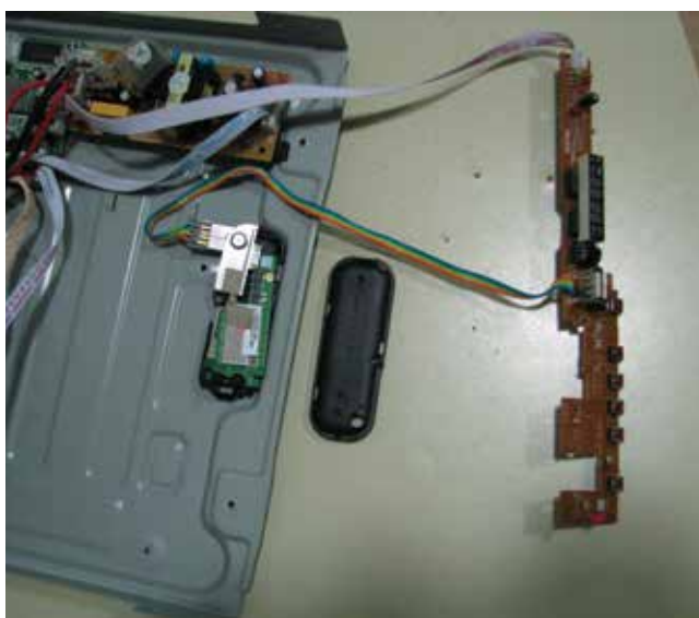
DVD je bil prirejen tako, da je bil preko njega možen dostop do spleta
