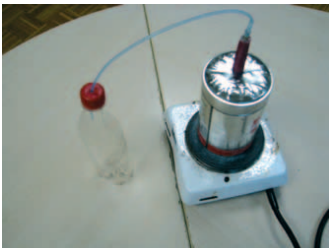
V zaporniški celici narejena miniatura naprava za kuhanje žganja
