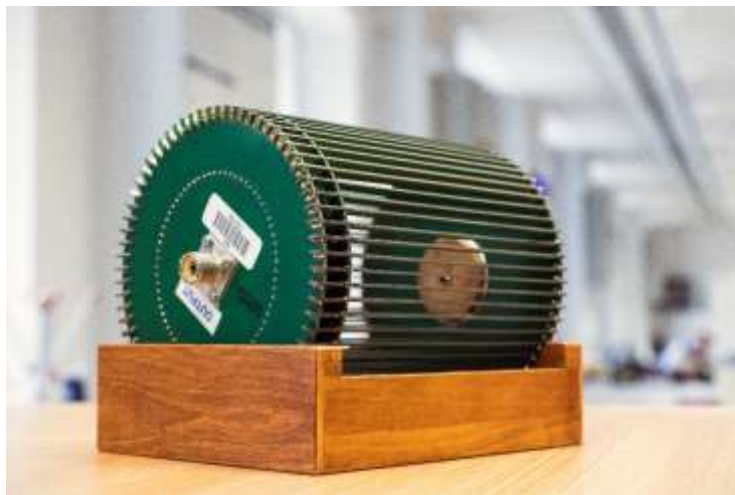
Koaksialni tokovni soupor izdelan v SIQ Ljubljana.
