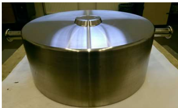
500 kg etalonska utež iz primerjave EURAMET.M.M-S7
