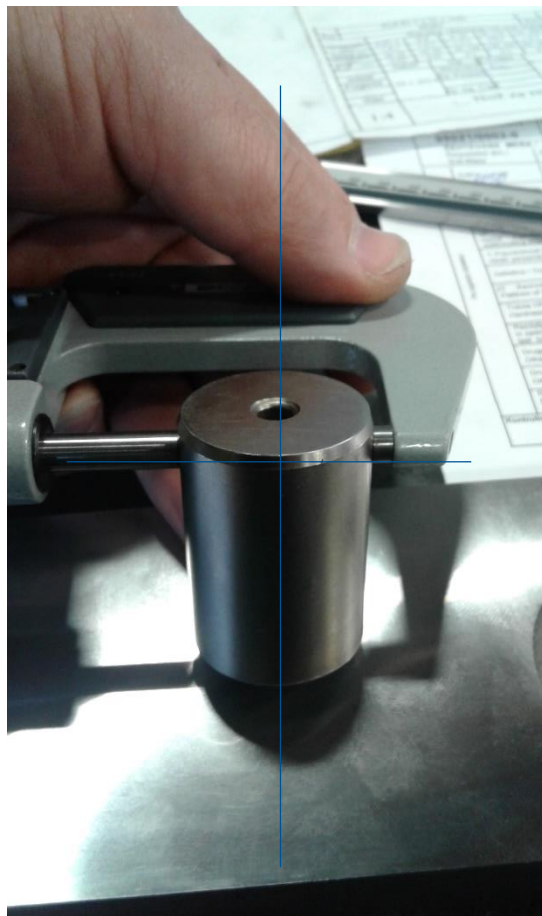
POMEMBNA JE PRAVOKOTNOST OSI MIKROMETRA IN OBDELOVANCA
