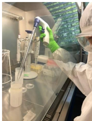
Prenos vzorca v Centrikon in centrifugiranje 30 minut
