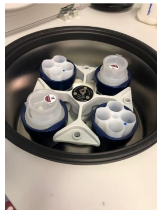
Prenos vzorca v Centrikon in centrifugiranje 30 minut
