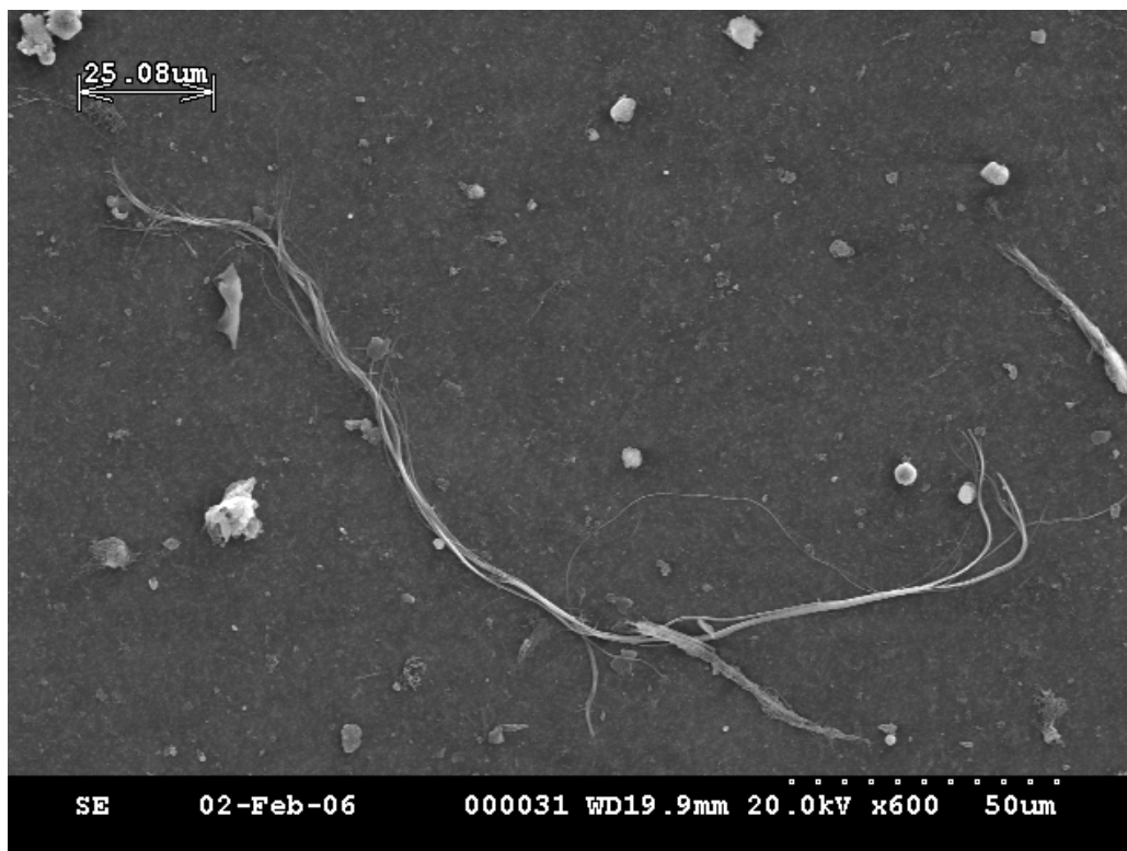
Slika 2.2: Vrščni elektronski mikrograf s prikazom vlaken azbesta krizotila
