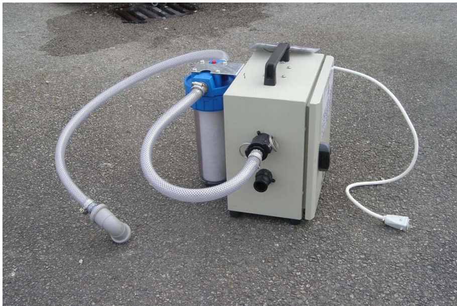
Slika 8.1: Filtracija vode za izpraznitev dekontaminacijske enote.
