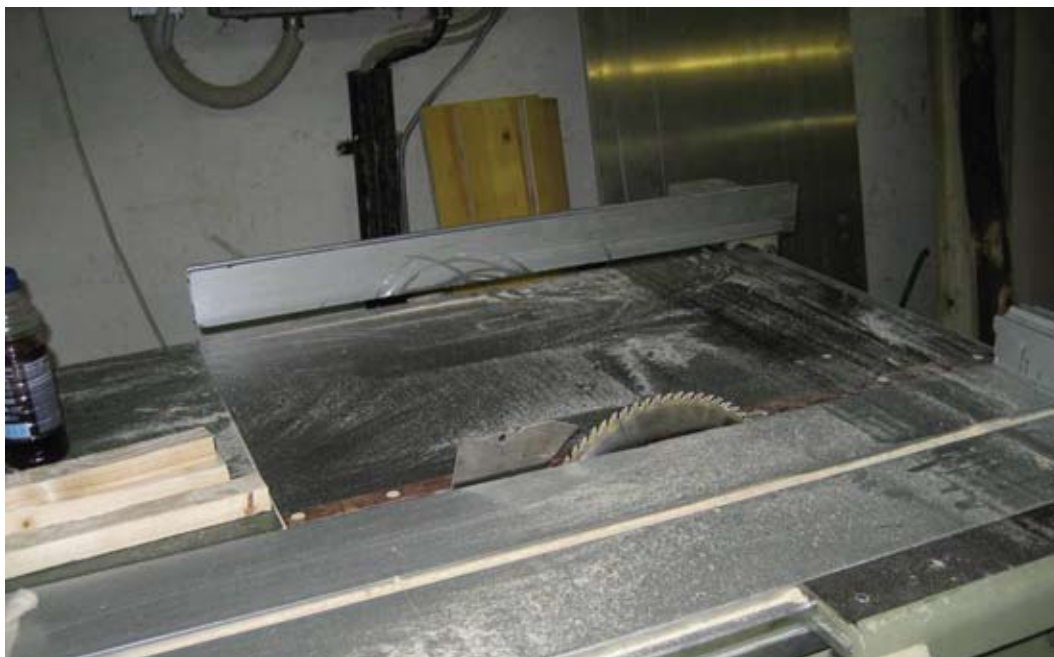
Slika 2: Neprimerna zaščita krožne žage
