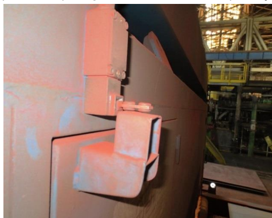
Slika 8: Neustrezno pritrjen vtič na vratih varnostnega stikala
