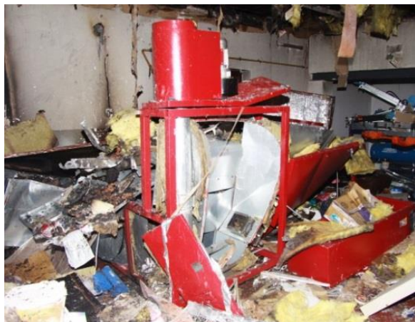
Slika 9: Eksplozija plina v stroju za sušenje majic
