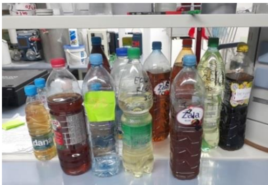
Slika 10: Neustrezno shranjevanje nevarnih snovi
