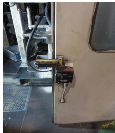
Slika 6: Odvijačena – premoščena varnostna ključavnica – omogočen vstop v notranjost stroja
