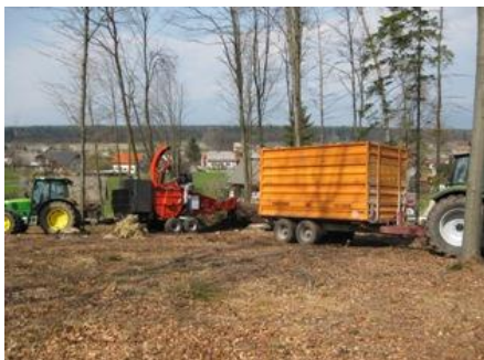
Sliki 6 in 7: Traktorski priključek za izdelovanje sekancev z nezaščitnimi vrtečimi deli je bil vzrok smrti študenta v letu 2011, IRSD
