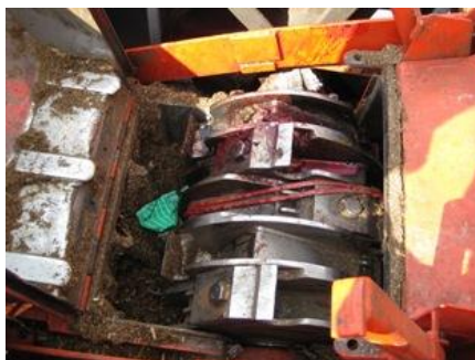
Sliki 6 in 7: Traktorski priključek za izdelovanje sekancev z nezaščitnimi vrtečimi deli je bil vzrok smrti študenta v letu 2011, IRSD
