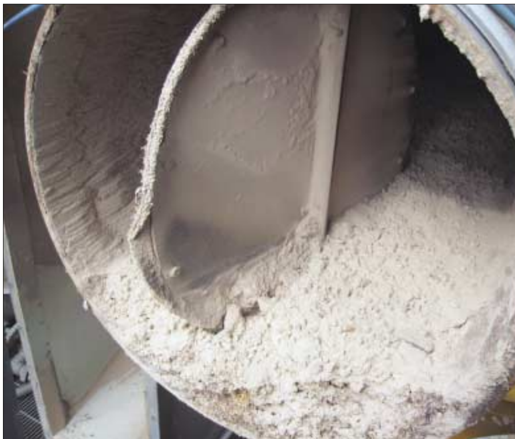
Slika 13: Fin lesni prah - vprašljivo čiščenje v področju eksplozijskih con
