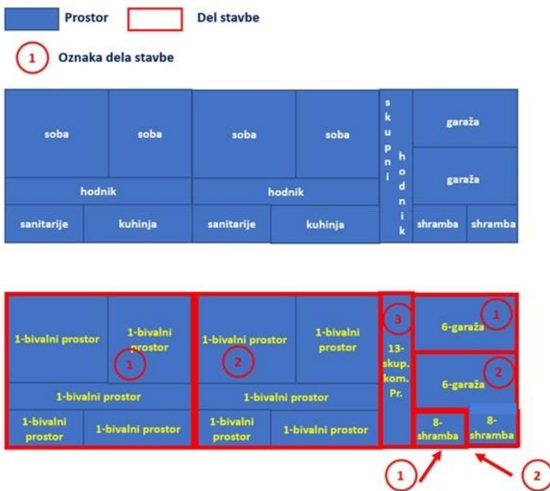
Slika 21: Določitev delov lokacijsko ločenim prostorom stanovanja
