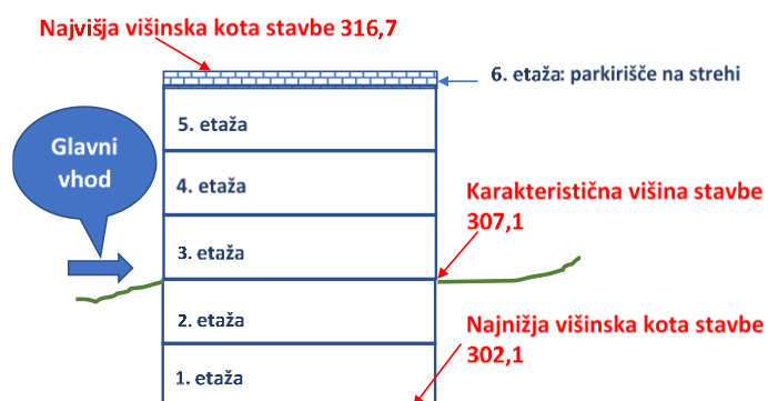
Slika 13: Višinske kote stavbe
