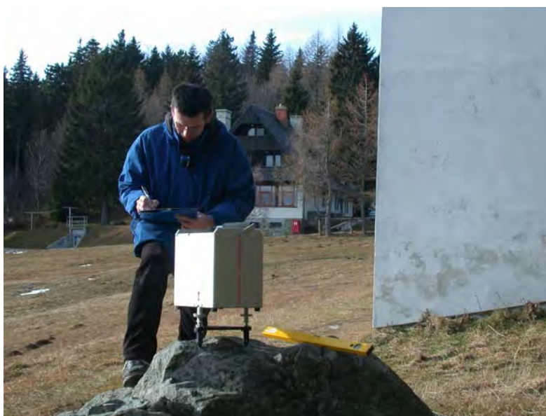
Slika 27: Gravimetrična izmera na reperjih
