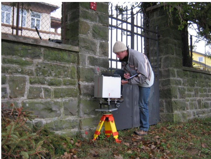
Slika 24: Gravimetrična izmera na reperjih
