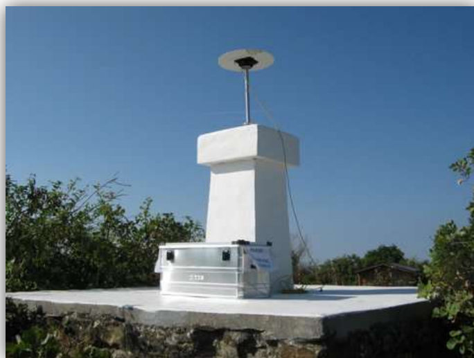
Slika 25: GPS meritve na TT 1. reda
