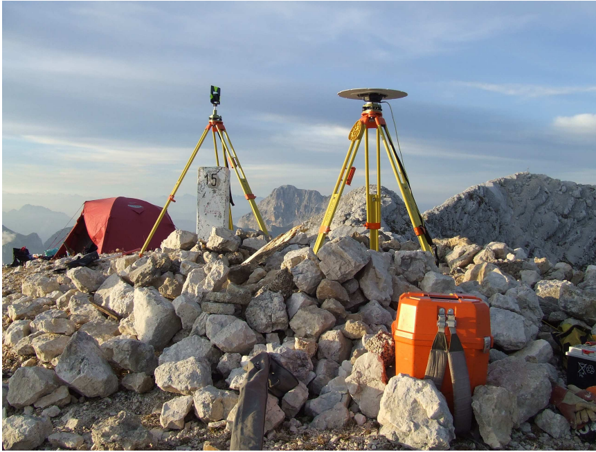
Slika 18: Izmera mikromreže trigonometrične točke 1. reda Kanin (foto Jože Miklič)
