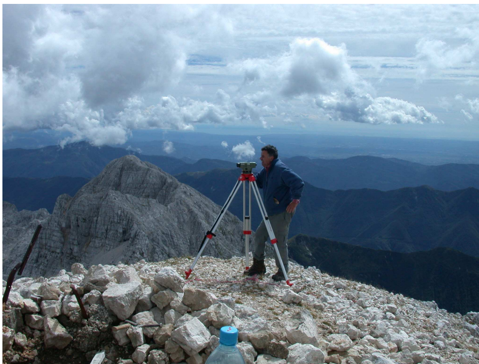
Slika 8: Izvajanje meritev za določitev transformacijskih parametrov (foto: Jože Miklič)
