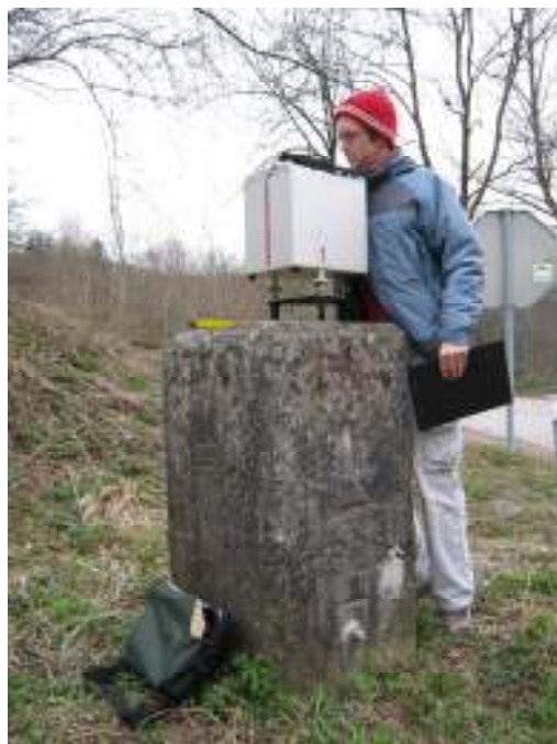
Slika 24: Gravimetrična izmera na reperjih
