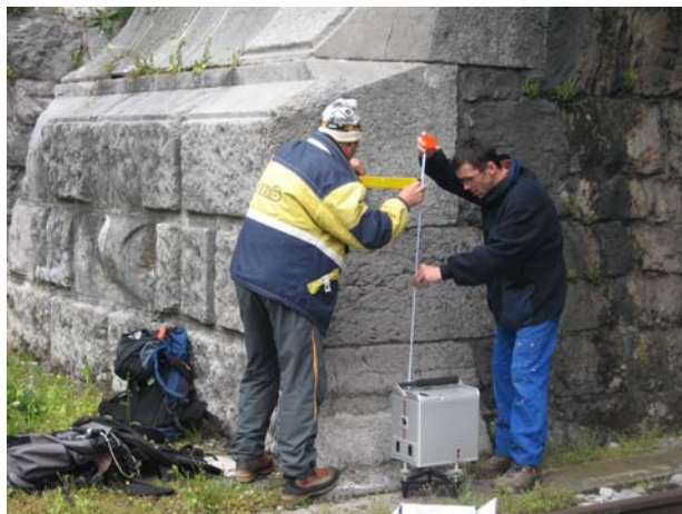
Slika 27: Gravimetrična izmera na reperjih
