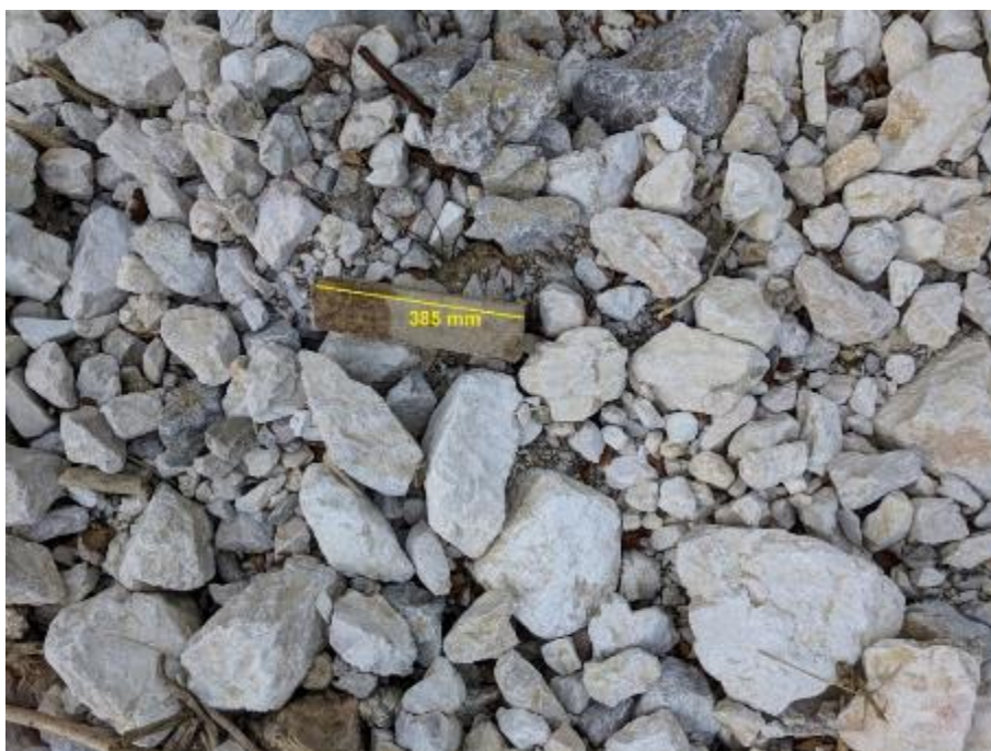
Slika 7. Primer ene od fotografij naplavin na območju zaplavnega prostora in merilo
