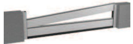
**34** Es ist darauf zu achten, dass die Damm balken mittig positioniert werden, sodass auf beiden Seiten der Abstand gleich ist.
