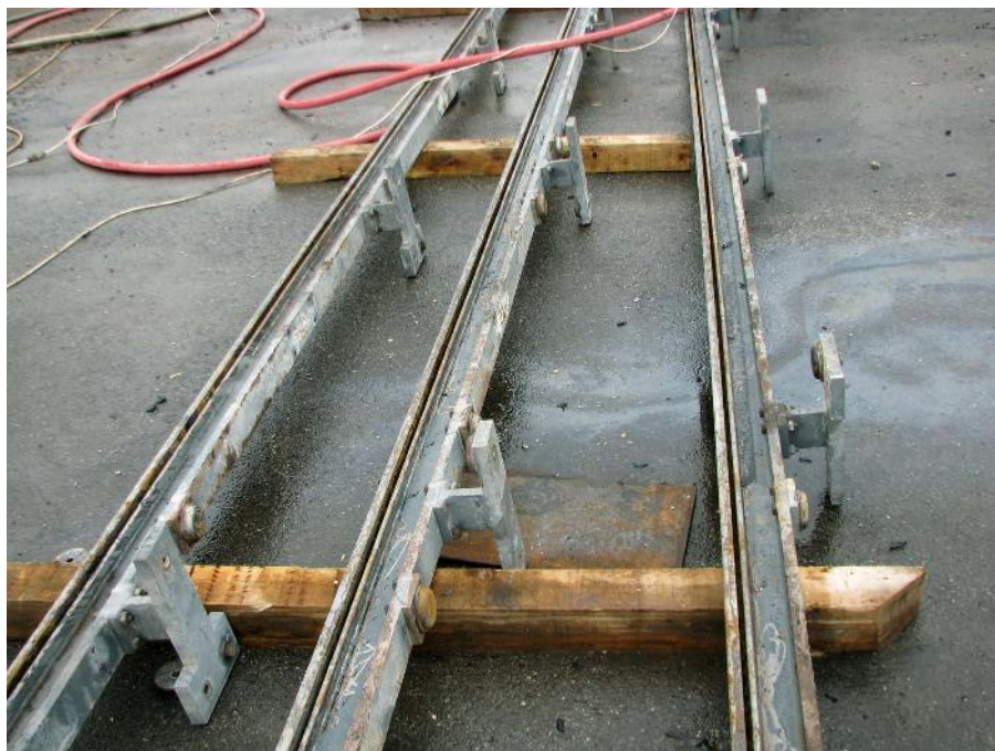
Slika 8.2: Razstavljena dilatacija na platoju v delavnici -vmesne lamele s krmilnimi deli
