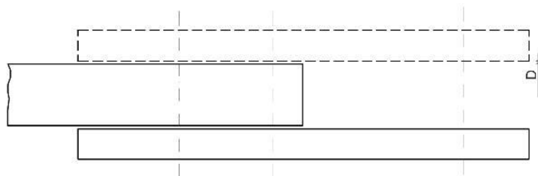
Slika 5.4: Skica odstopanja od ravnosti med podlago in jekleno ploščo – D, po SIST EN 1090
