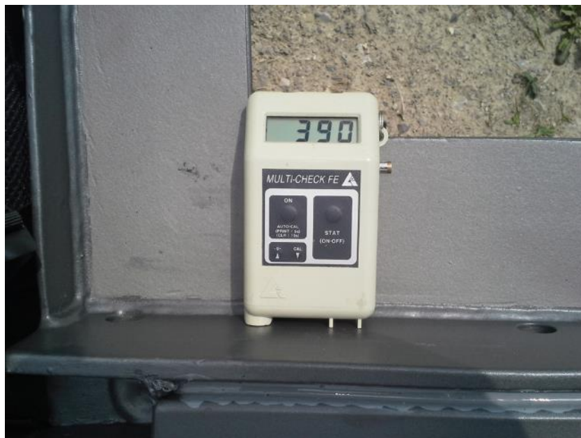
Slika 9.2: Merjenje debeline prevleke - magnetna metoda
