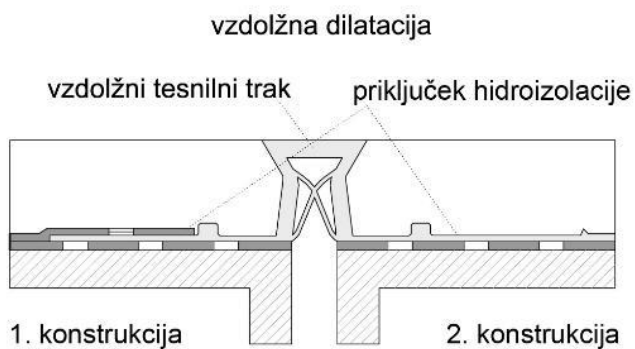
Slika 3.19: Primer vzdolžne dilatacije železniškega premostitvenega objekta
