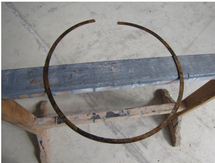
Slika 100: Medeninasto notranje tesnilo elastomerne blazine lončnega ležišča.
