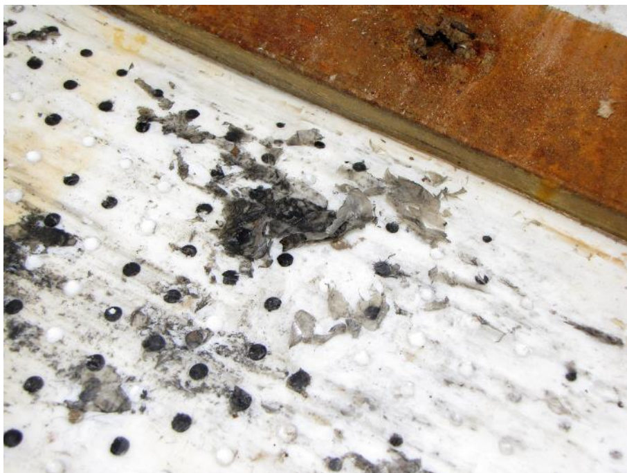
Slika 93: Struženje površine teflonskega diska.
