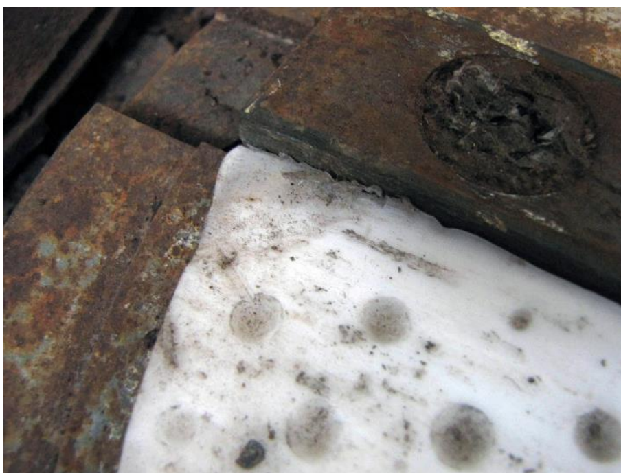
Slika 92: Pravilna usmerjenost žepkov teflonskega diska na batnici lončnega ležišča. Deformirani teflonski disk zaradi iztiskanja na robu utora diska ob vzdolžnem vodilu.
