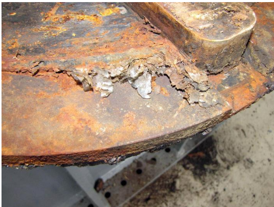
Slika 99: Ostanki ostružkov teflonskega diska na robu utora batnice.
