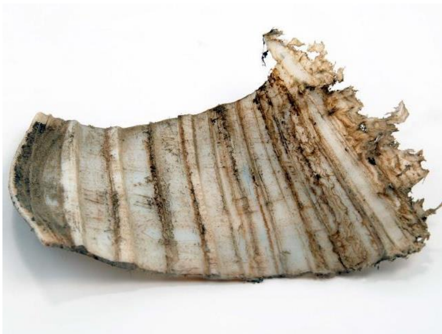
Slika 81: Del iztisnjenega teflonskega diska (po demontaži ležišča).
