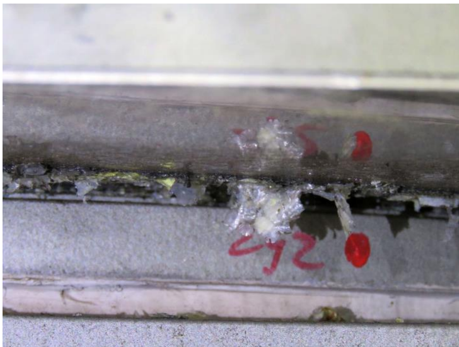
Slika 131: Struženje teflona drsnega diska lončnega ležišča.
