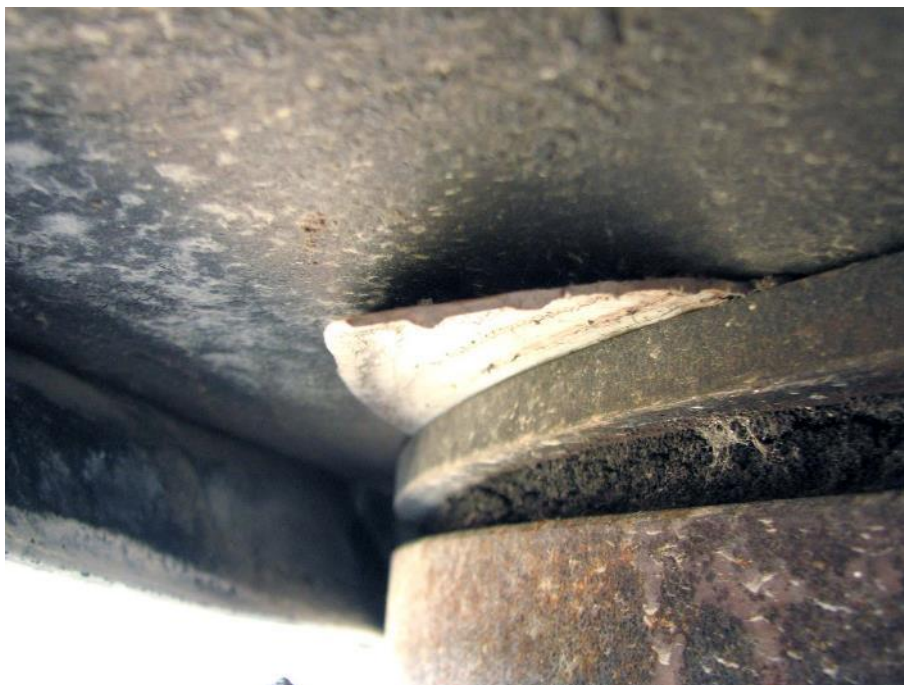
Slika 80: Iztiskanje teflonskega diska iz ohišja batnice.
