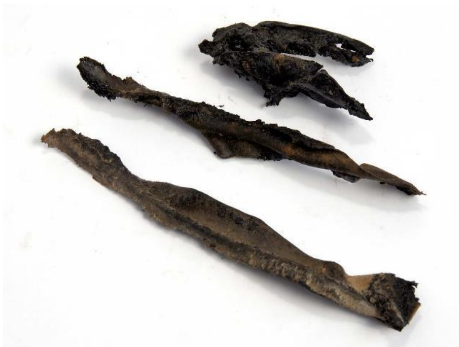
Slika 85: Iztisnjeni ostanki elastomerne blazine.
