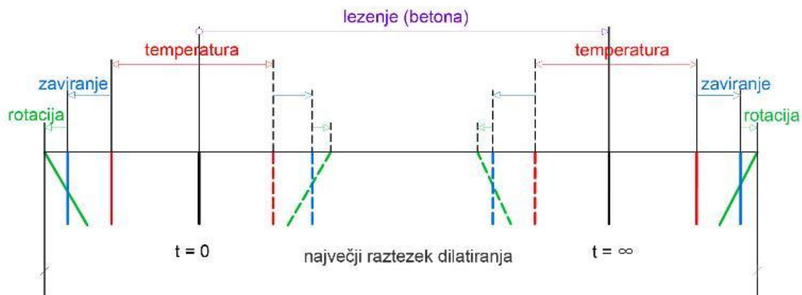
Slika 4.2: Shema dilatiranja gradbene odprtine zaradi temperature, zaviranja, rotacij in drugega v vzdolžnem prerezu premostitvenega objekta za čas 0 in neskončno
