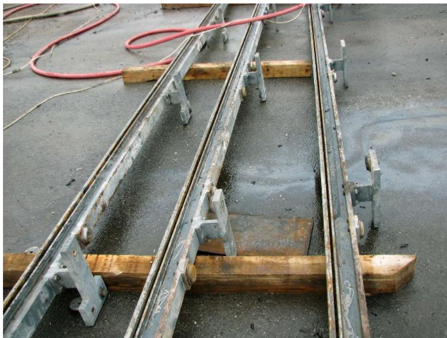
Slika 8.2: Razstavljena dilatacija na platuju v delavnici -vmesne lamele s krmilnimi deli
