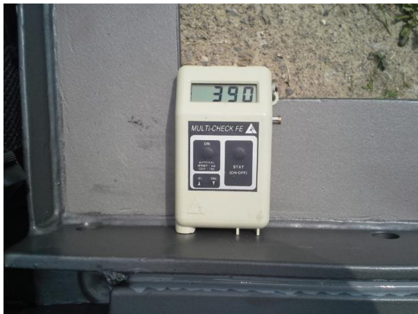
Slika 9.2: Merjenje debeline prevleke - magnetna metoda
