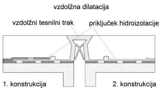
Slika 3.19: Primer vzdolžne dilatacije železniškega premostitvenega objekta
