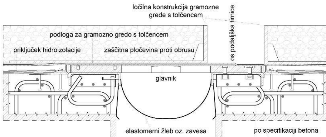
Slika 4.23: Shematski prikaz železniške konzolne glavnikaste dilatacije v povezavi s tirno gredo za velike in zelo velike pomike ter način odvodnjavanja z zaveso spodaj
