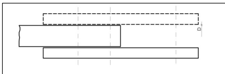
Slika 13.22: Toleranca (D) v naležni ravnini med sestavnimi deli po SIST EN 1090-2
