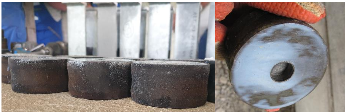
Slika 13.33: Obrus drsnega materiala (PTFE) lamelne dilatacije po 9 mesecih uporabe zaradi povečanega prometa (5000 težkih tovornjakov dnevno), resonance dilatacije, posledično vibracij-pomikov drsnih ležišč
