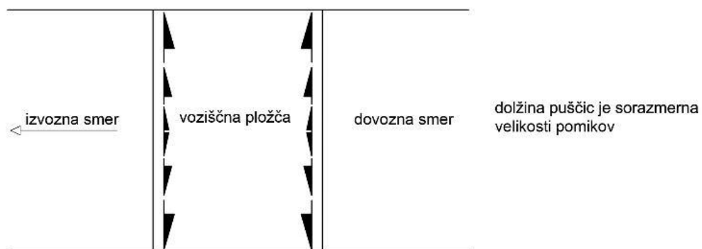
Slika 4.6: Shema vpliva torisno široke in kratke prekladne konstrukcije z dilatacijama
