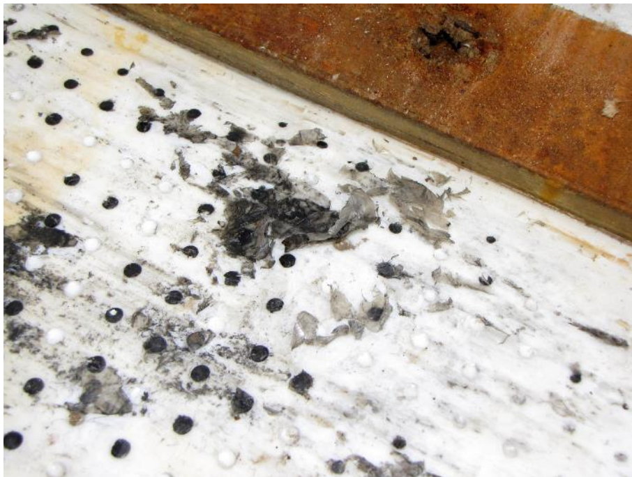
Slika 93: Struženje površine teflonskega diska.
