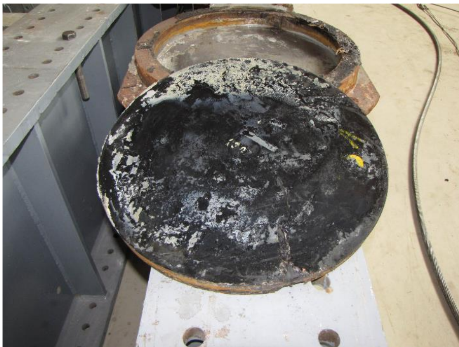
Slika 89: Kontaktna površina elastomerne blazine z dnom lonca.
