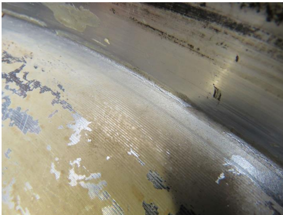
Slika 134: Razpoke v stiku dna lonca s steno lonca zaradi deformacije dna lonca.
