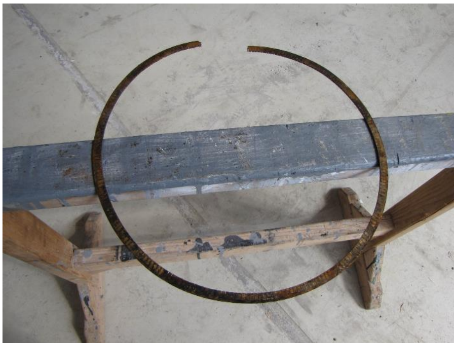
Slika 100: Medeninasto notranje tesnilo elastomerne blazine lončnega ležišča.
