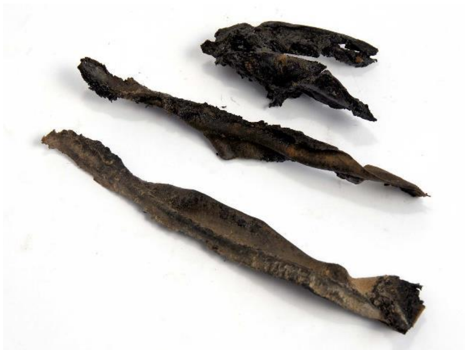
Slika 85: Iztisnjeni ostanki elastomerne blazine.
