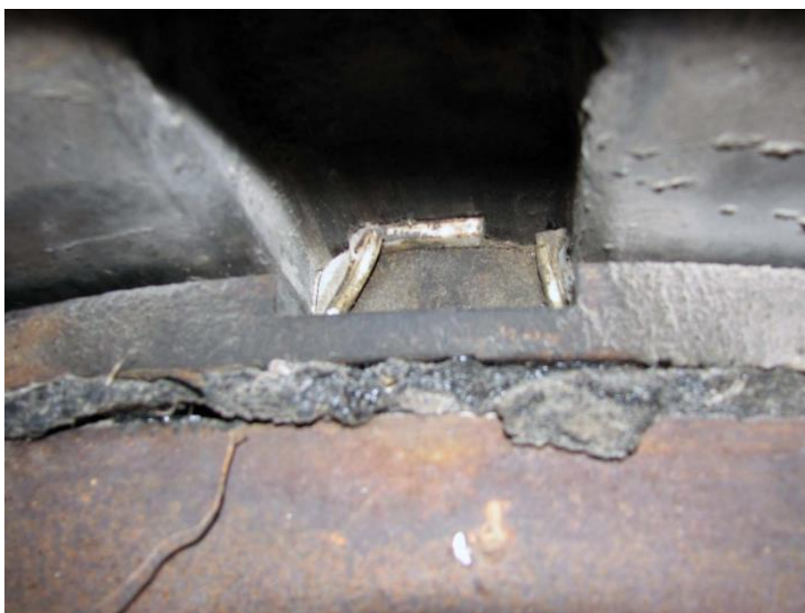
Slika 82: Iztiskanje teflonskega diska iz batnice v utor vzdolžnega vodila.
