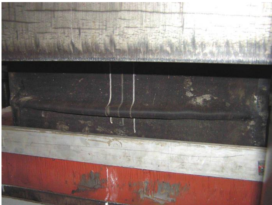
Slika 25: Lokalno izrazita guba zaradi napake med procesom vulkanizacije.
