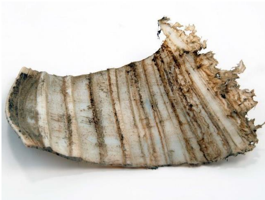
Slika 81: Del iztisnjenega teflonskega diska (po demontaži ležišča).
