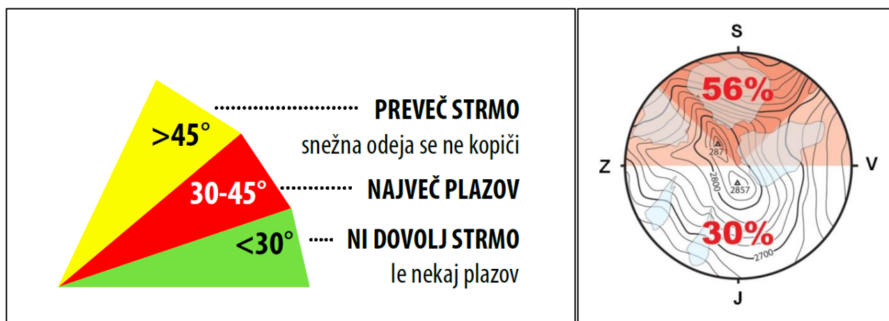
Slika 19: Večina plazov se proži na strminah z naklonom 30–45 (levo) in v osojah (desno) zaradi počasnejše preobrazbe in s tem utrditve oziroma stabilizacije snežne odeje.
