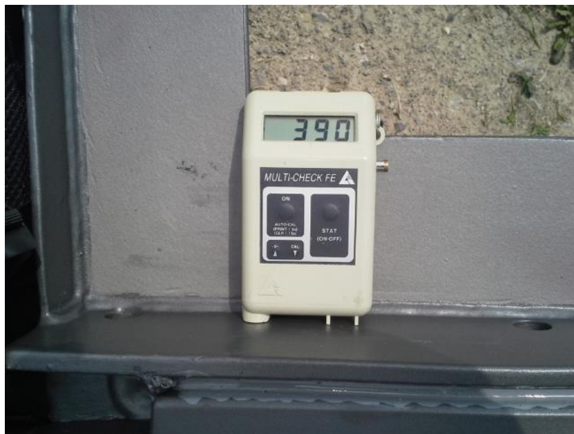
Slika 9.2: Merjenje debeline prevleke - magnetna metoda
