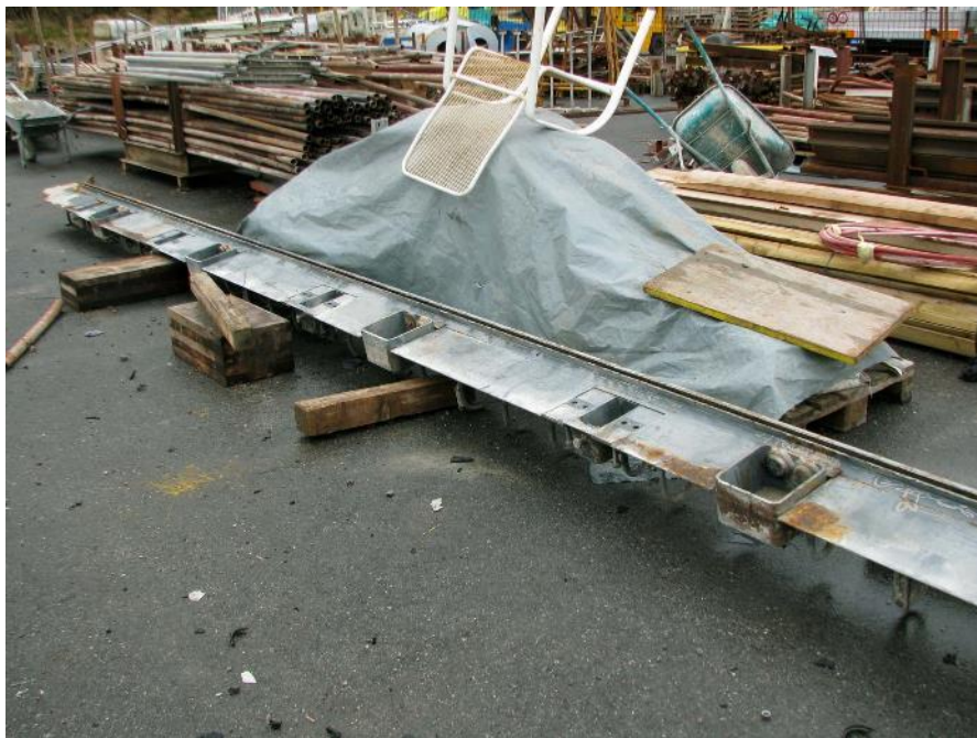
Slika 8.1: Razstavljena dilatacija na platuju v delavnici- robni profil z zabojniki
