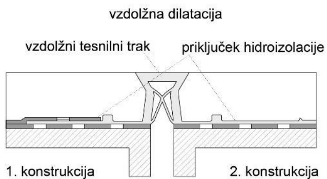
Slika 3.19: Primer vzdolžne dilatacije železniškega premostitvenega objekta
