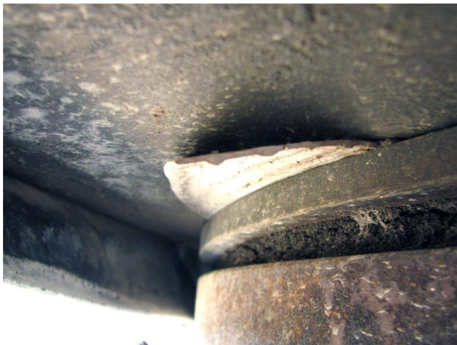
Slika 80: Iztiskanje teflonskega diska iz ohišja batnice.
