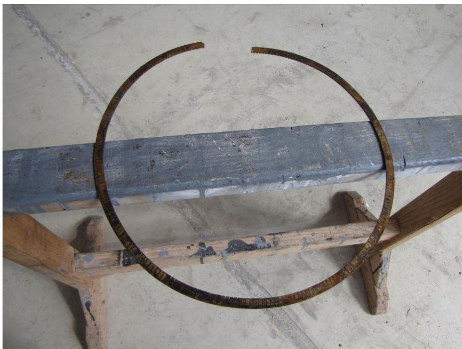
Slika 100: Medeninasto notranje tesnilo elastomerne blazine lončnega ležišča.
