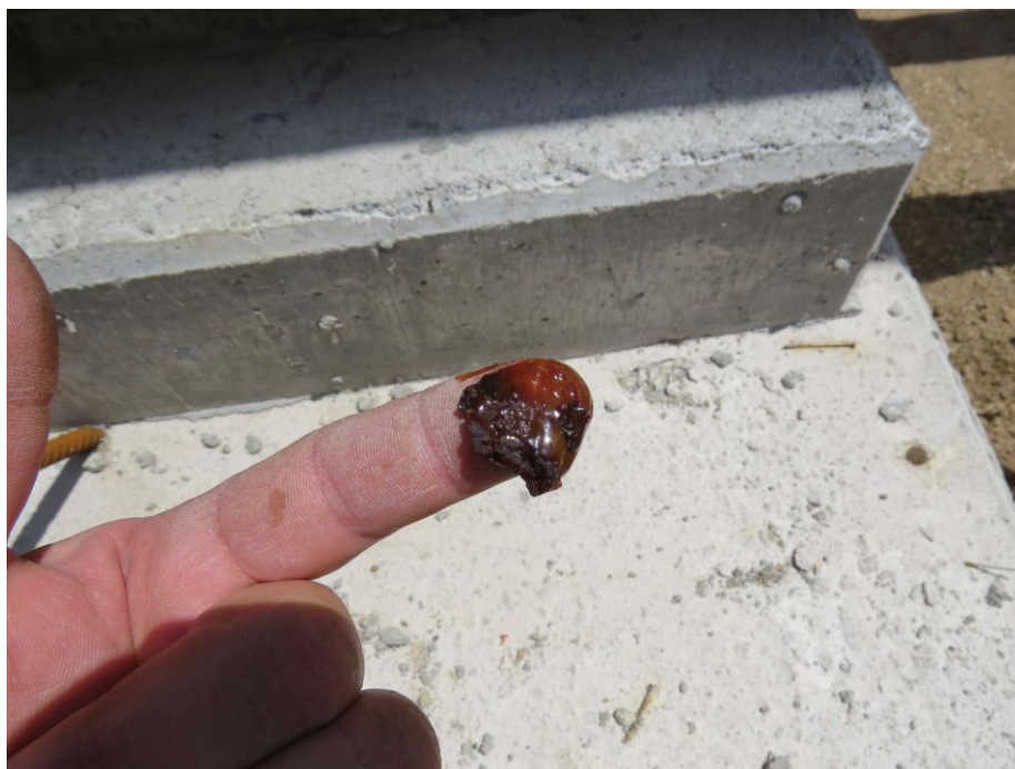
Slika 68: Neustrezno zreagiranje epoksidnega lepila, ki zato deluje kot mazivo v stiku.
