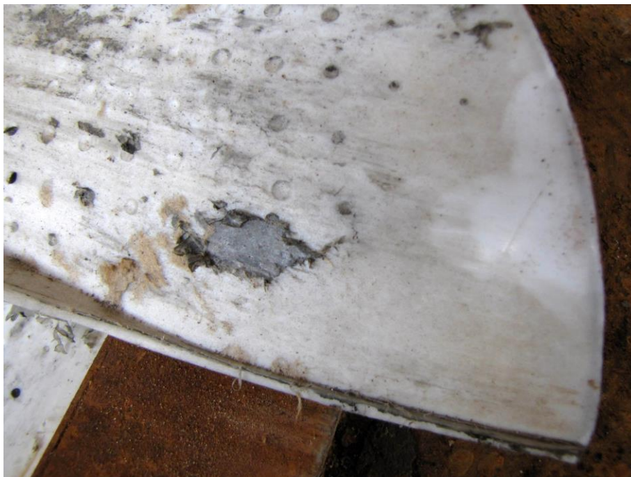
Slika 94: Obraba površine teflonskega diska v območju roba utora batnice in centralnega vodila.
