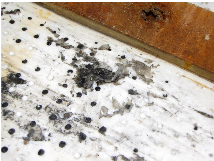
Slika 93: Struženje površine teflonskega diska.
