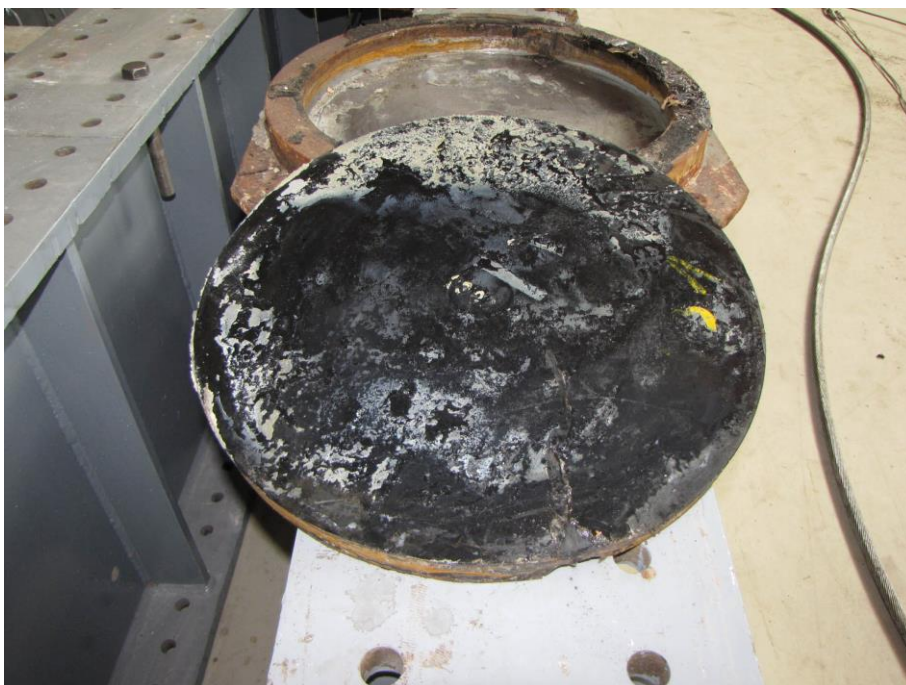
Slika 89: Kontaktna površina elastomerne blazine z dnom lonca.
