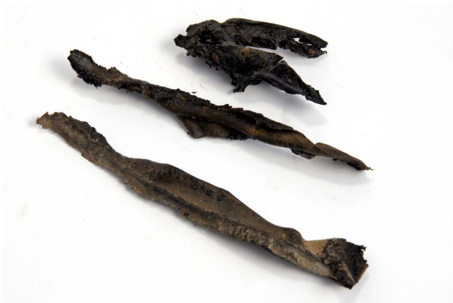
Slika 85: Iztisnjeni ostanki elastomerne blazine.
