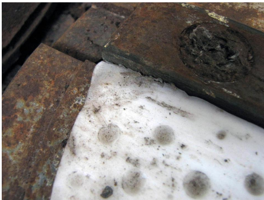
Slika 92: Pravilna usmerjenost žepkov teflonskega diska na batnici lončnega ležišča. Deformirani teflonski disk zaradi iztiskanja na robu utora diska ob vzdolžnem vodilu.
