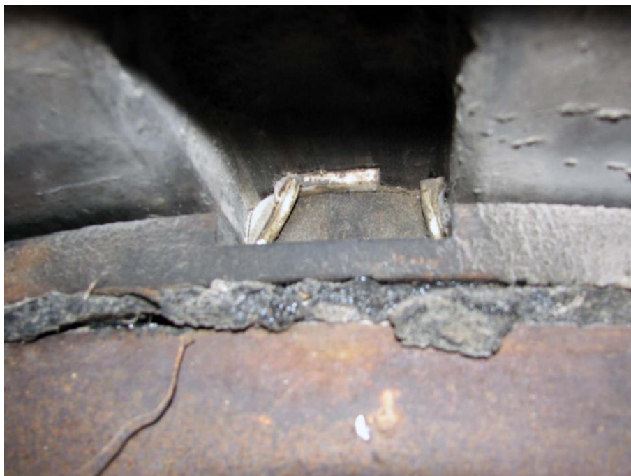
Slika 82: Iztiskanje teflonskega diska iz batnice v utor vzdolžnega vodila.
