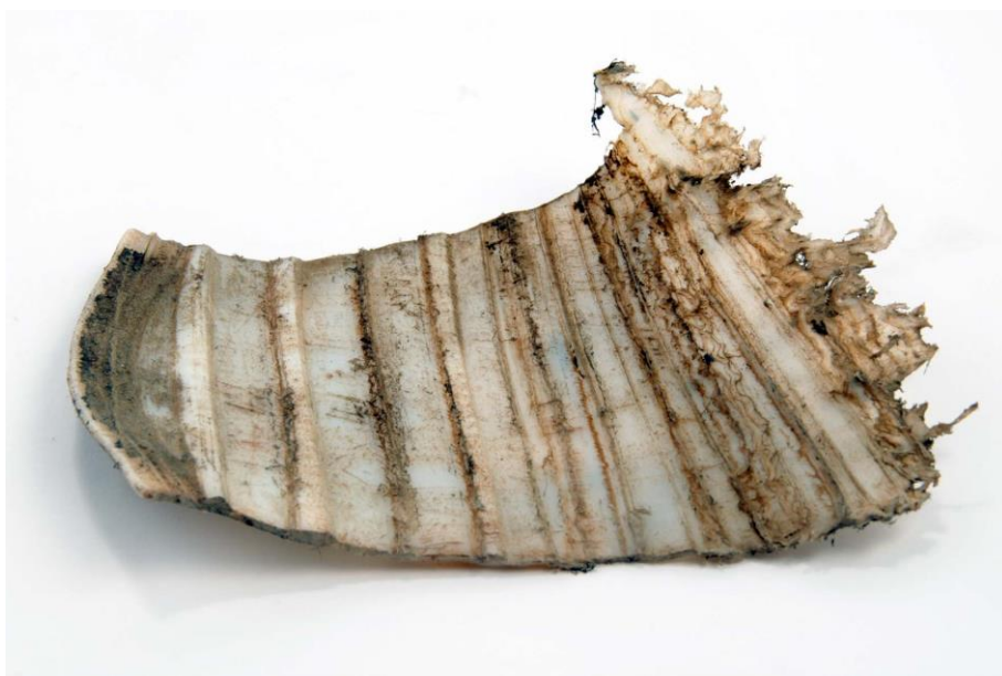
Slika 81: Del iztisnjenega teflonskega diska (po demontaži ležišča).
