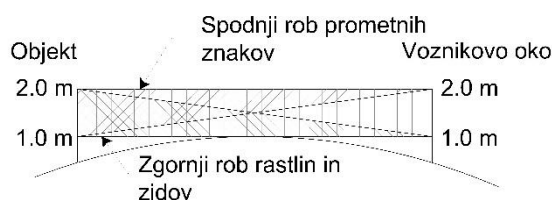
Slika 4.17: Pregledno polje – na uvozu (pogled v levo) in na območju krožnega vozišča
