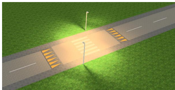
Slika 44: Primer postavitve svetilk za osvetlitev ploščadi trapezne oblike s preходом za pešce na neobremenjenem delu ceste znotraj naselja
