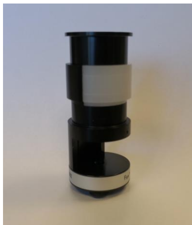
Slika 54: Merilnik za merjenje polcilindrične osvetljenosti
